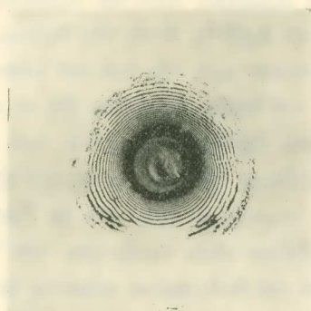
Εἰκ. 2.— Ἐπίδρασις συνεχοῦς ρεύματος ἐπὶ τῶν ἀνωτέρω δακτυλίων ἐντάσεως 0,2 mA καὶ τάσεως 9 V. Τὰ ἀργυρᾶ ἠλεκτροδία εἶναι τοποθετημένα εἰς τὰ δύο ἄκρα τῆς φερούσης τὴν διχρωμικὴν ζελατίνην ὑαλίνης πλακός. Γίνεται ἤδη καταφανὴς ἡ ἀνοδικὴ περιοδικὴ κατακρήμνησις πλησίον τοῦ + ἠλεκτροδίου ἄνευ παρουσίας \text{AgNO}_3
