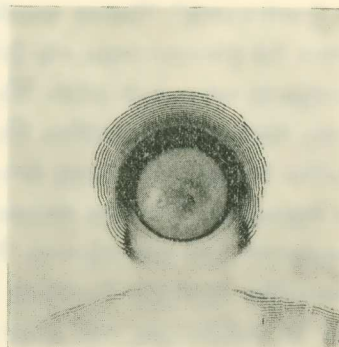
Εἰκ. 4.— Ἐντασις ρεύματος 0,7-0,8 mA καὶ 22 V. Ἡ ἀνοδικὴ περιοδικὴ κατακρήμνησις εἶναι λίαν ἐμφανής.
