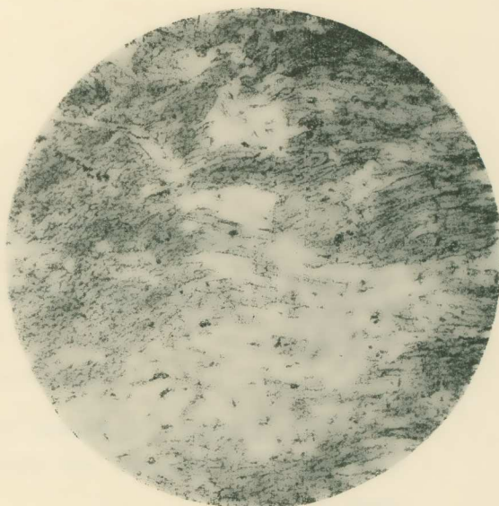
Είχ. 2. - Μεγάλος κρύσταλλος κερκοσίλβης (ἀριστερὰ) μετὸν παραλλήλογραμμον πρισματικὸν σχισμόν, ἀναλυόμενος εἰς σχισμογενὴ πρισματῖδια μετατοπιζόμενα παραλλήλως (πρὸς τα δεξιὰ). Γράμμ. μεγεθ. \times 37 .
