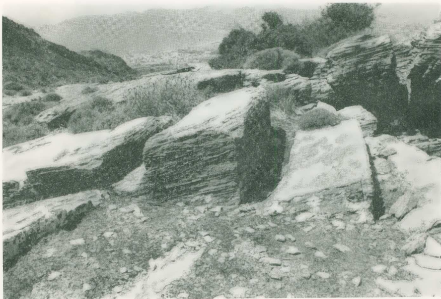
Εἰκ. 2.—Ἐξόρυξις ὀρθογωνίων ὀγκολίθων διὰ διανοίξεως περιφερειῶν ἀλάκων (φαλκῶν) καὶ δι' ἀποκολλήσεως κατὰ τὰς ἐπιφανείας καλῆς σχιστότητος. Ἀρχαία λατομεῖα βορείως τῶν Μύλων.
