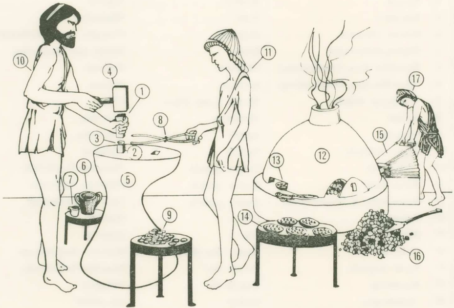
Εἰκ. 1. Παράστασις τῆς τεχνικῆς τῆς κοπῆς ἀργυρῶν νομισμάτων εἰς Ἀθηναϊκὸν νομισματοκοπεῖον τοῦ 5ου αἰῶνος π. Χ. κατὰ τὰ δεδομένα τῆς ἀνά χειρὸς μελέτης.
