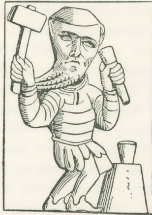
Εἰκ. 14. Παράστασις νομισματοκόπτου εἰς ἀνάγλυφον τοῦ 10 ου αἰῶνος μ. Χ., εἰς ἐκκλησίαν. Ὁ κάτω σφῆν εἶναι κωνικὸς καὶ στηρίζεται ἐντὸς κοιλό- τητος τοῦ ἄκμονος.
