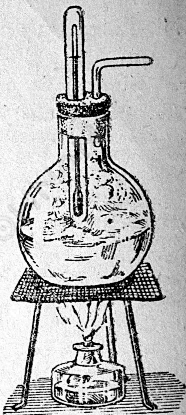
Σχ. αρ. 77. Το θερμόμετρο μέσα στους ατμούς του βράζοντος νερού
