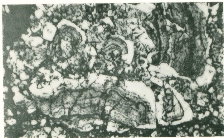
Εικ. 6.—Δομὴ γέλης σιδηροσπυρίτου. Κατακλαστικὸς ἴστος. Μεγ. \times 210 . Ἐλαιοκατ. Μικ. ἐπ. Abb. 6.—Gelstruktur von Pyrit. Kataklastisches Gefüge. Vergr. 210mal. Ölim. Geätzt.
