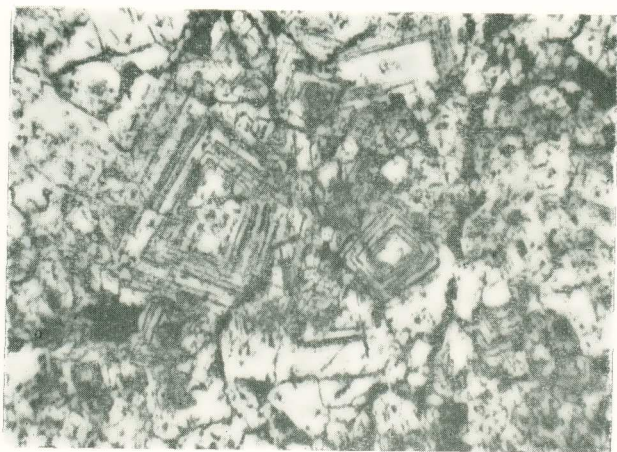
Εἰκ. 7.—Τυπικὴ ζωνώδης δομὴ τοῦ σιδηροπυρίτου. Ἐμφανὴς καὶ ὁ κατακλαστικὸς ἵστός. Μεγεθ. \times 210 . Ἐλαιοκατ. Μικ. ἔπ.
