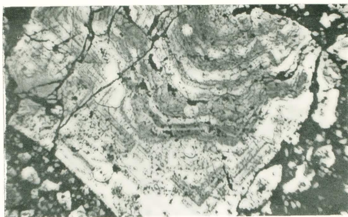
Εικ. 5.—Μετάβασις ἐκ τῆς κολλοειδοῦς πρὸς τὴν ζωνώδη δομὴν. Σιδηροσπυρίτης. Μεγ. \times 150 . Ἐλαιοκατ. Μικροχημ. ἐπίδρασις. Abb. 5.—Übergang von Gel- zu Zonarstruktur. Pyrit. Vergr. 150mal. Ölim. Geätzt.
