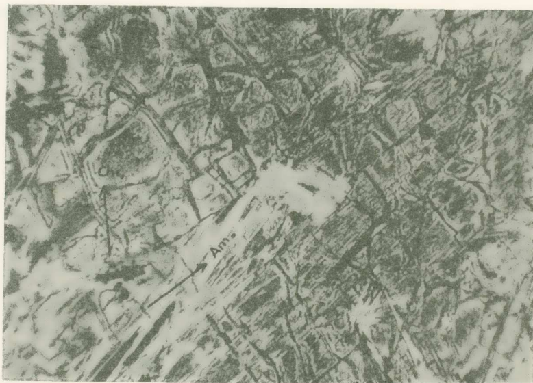
Abb 6. Chrysotilserpentin mit der charakteristischen Maschenstruktur aus Peridotit oder Dunit entstanden (Chr.). In der Mitte des Bildes in einem Haarriss bildet sich Amianth (Am). Dünnschliff in + Pol. aus «Kato Theodoraki» bei Kilkis Nordgriechenlands.
