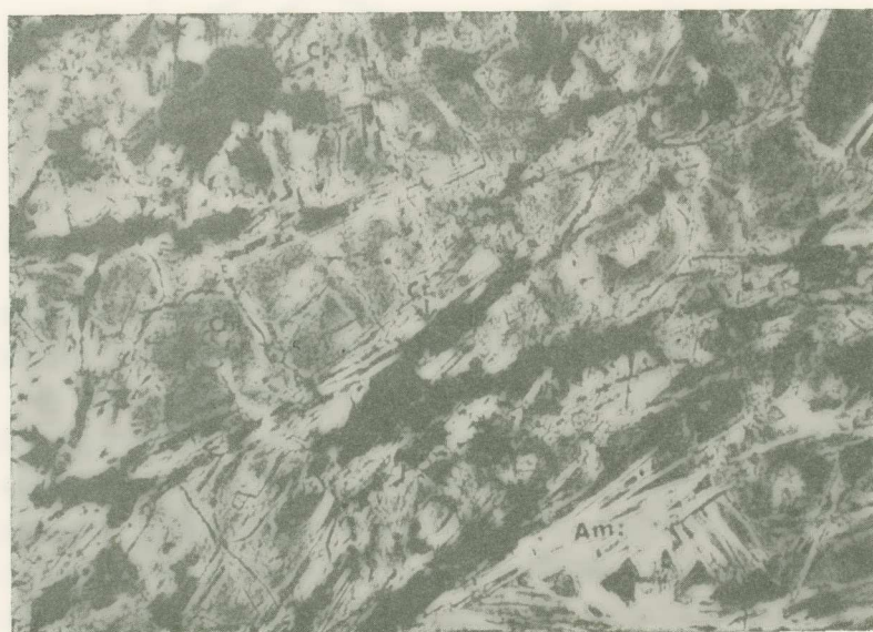
Abb. 3. Chrysotilminerale mit der bekannten Maschenstruktur (Chr. grau). Dunklere Stellen Chromerz (Cr). Dünnschliff in + Pol. Aus dem Serpentin «Kato Theodoraki» bei Kilkis Nordgriechenlands.
