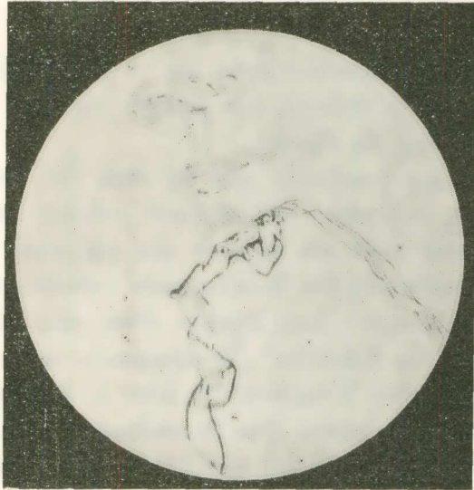
Εικ. 5α. - Ἡ ἰς τῆς εἰκόνος 5 ἐξεδιπλώθη ἑνταῦθα εἰς μέγαν βαθμὸν διὰ τῆς ἐπιδράσεως τοῦ νατροορύματος.
