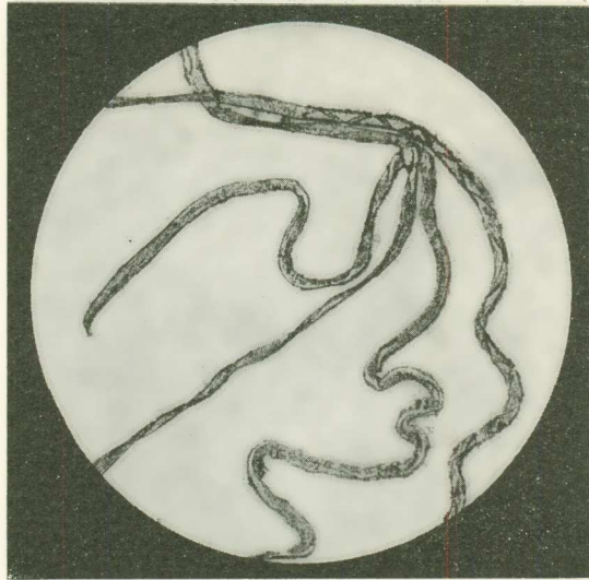
Εικ. 4. - Παρίσταται ἕς βάμβακος ἄνευ συστροφῶν, συνήθων ἢ ἀσυνήθων, ἄλλη μετὰ συνήθων συστροφῶν καὶ τρίτη μετὰ συνεχῶν ἀσυνήθων συστροφῶν, αἱ ὁποῖα κάμνουν νὰ φαίνηται αὕτη ὡς ἡ ἐν τῇ εἰκόνι ἀρ. 2 ἕς.
