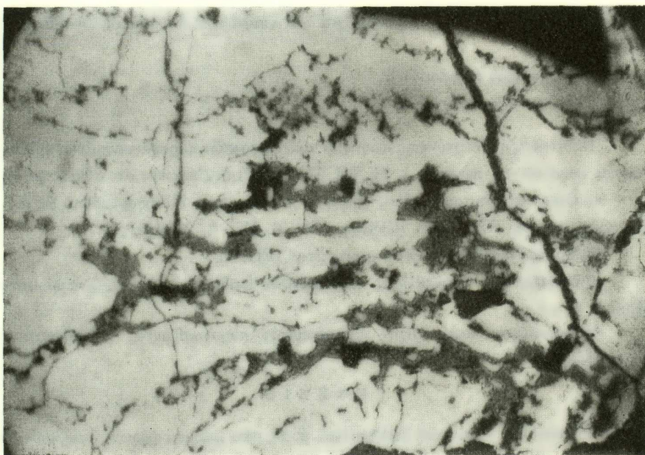
Είχ. 5.— Βαλλερύτης ἀναπτυσσόμενος κατὰ μήκος ρωγμῶν μαγνητοπυρίτου. Nicols //, \times 80
