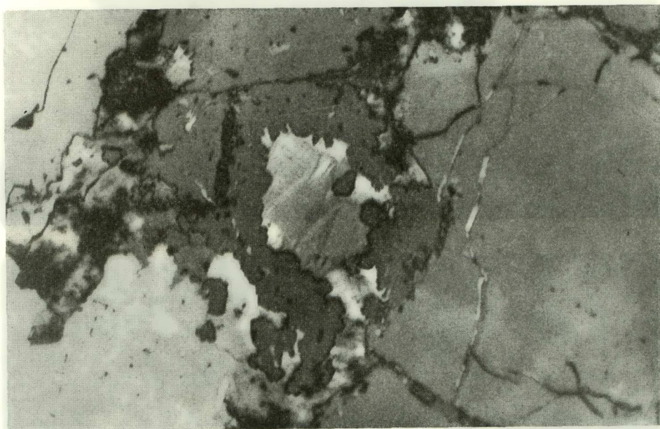
Εἰκ. 2.— Κρύσταλλος βαλλερίτου ἐντὸς σερπεντίνου. Διακρίνεται εἰς τὸ δεξιὸν τῆς εἰκόνος ὁ χρωμίτης, εἰς δὲ τὸ ἀριστερὸν ὁ μαγνητοπυρίτης. Nicols //, \times 100
