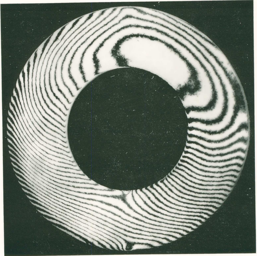
Αί απεικονίσεις τῶν κρουσσῶν συμβολῆς κατὰ τὴν ἀφόρτιστον κατάστασιν δακτυλίου θλιβομένου ἄξονικῶς.
