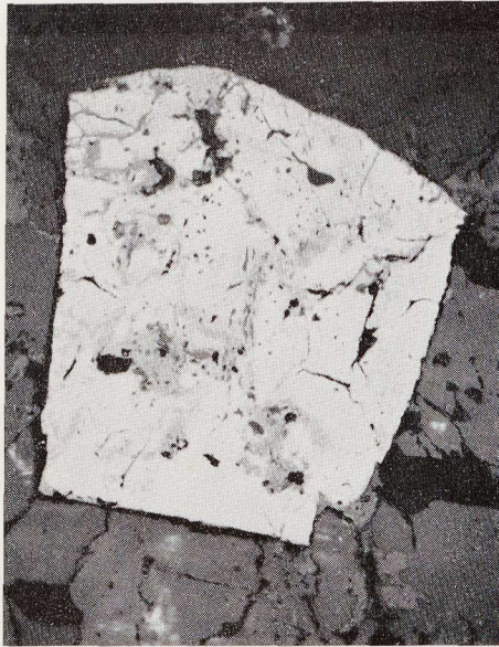
Fig. 3.—Nadeleisenerz (dunkel) und Rubinglimmer (hell) in Pseudomorphose nach einem Pyritwürfel. Vergr. 60, Nic. parallel. Im Luft. Kithada.
