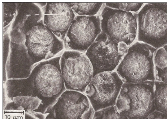
Σχ. 25: Εικόνα ληφθεῖσα με ἠλεκτρονικὸ μικροσκόπιο διατομῆς τοῦ συνθέτου ὑλικοῦ, ἀπὸ τὴν ὁποία ἐμφαίνονται οἱ περιοχὲς ἀστοχίας τῆς μήτρας στὴ διεπιφάνεια μετὰ τὶς ἴνες.
