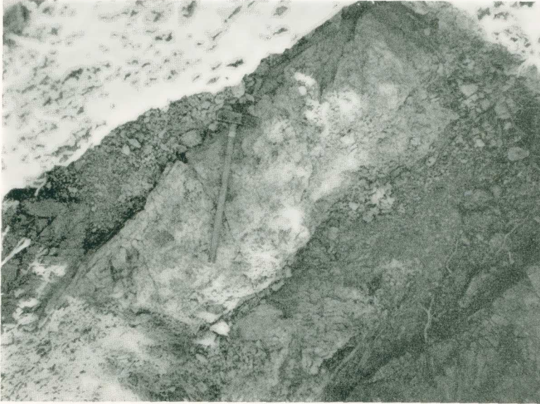
Είχ. 1.—Χαλαζιακή υδροθερμική φλέψ μετά χαλκούχων όρυκτων, διασχίζουσα τόν πορφυρίτην. Παρά τόν συνοικισμόν Φλώκα Φοινικίου.
