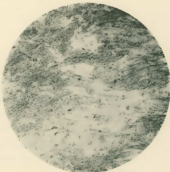
Είχ. 2. - Μεγάλος κρύσταλλος κερροστίλβης (ἀριστερὰ) μετὸν παραλλήλογραμμον ποιοματικὸν σχισμὸν, ἀναλύμενος εἰς σχισμογενῆ ποιοματίδια μετατοπιζόμενα παραλλήλως (πρὸς τα δεξιὰ). Γραμμ. μεγεθ. \times 37 .
