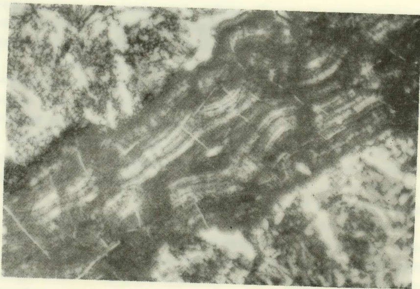
Εικ. 3. Στρωματοειδείς - βοτρυοειδείς συγκεντρώσεις ἐκ στιφροῦ χαλαζίου ἐντὸς σερπεντίνου. Ἄγ. Ἀνάργυροι Ἑρμιόνης, Nicols //, \times 21 .
