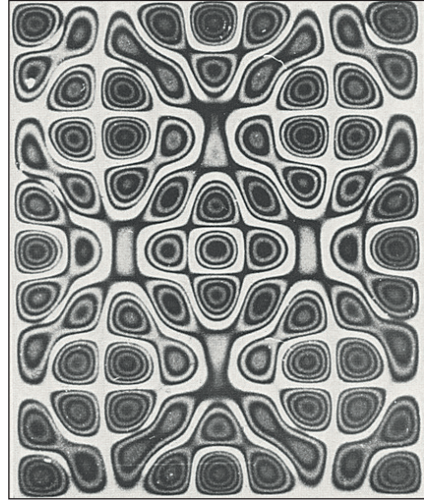
Σχῆμα 49: Ἰνδικό μοτίβο. Ὀλογραφική ἀπεικόνιση τῶν μορφῶν δονήσεων πλάκας ἀπὸ ἀλουμίνιο.
