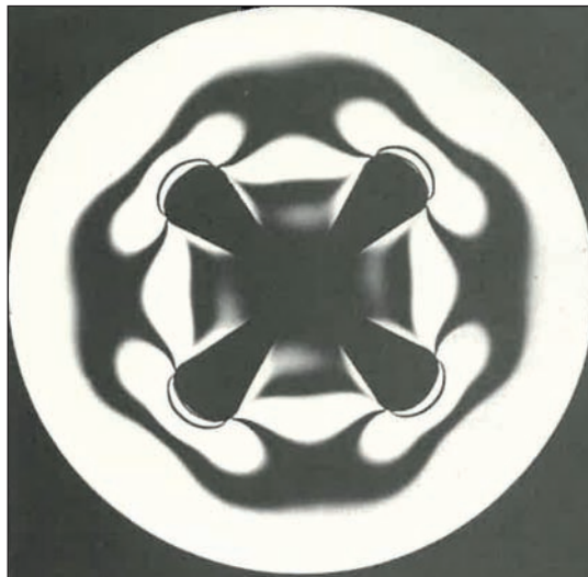
Σχῆμα 44: Νυκτερινὸ ἄστρο. Σκοτεινὸ πεδίο ἰσοχρῶμων σὲ στερεὸ προωθητῆ ὀπτοῦς ὑπόκειται σὲ ὁμοιόμορφη πίεση.
