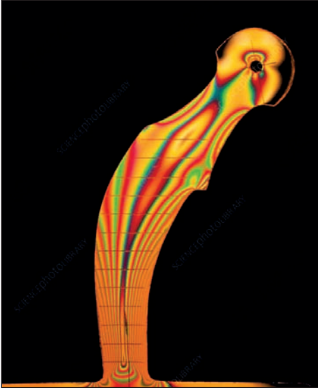
Σχῆμα 37: Ίσοχρωματικοί κροσσοί συμβολῆς σὲ μονόπακτο πρόβολο μεταβλητῆς διατομῆς ὑποβαλλόμενο σὲ συγκεντρωμένο φορτίο στὸ ἄκρο του.
