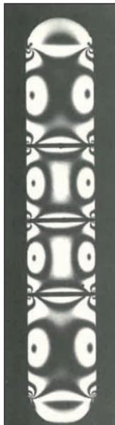
Σχῆμα 42: Στύλος τοτέμ. Ίσοχρωματικοὶ κροσσοὶ σὲ λωρίδα ἐλαστικοῦ πὸν εἶναι συγκολλημένη κατὰ μῆκος τῶν πλευρῶν της σὲ ἄκαμπτες ράβδους καὶ συρρικνοῦται.
