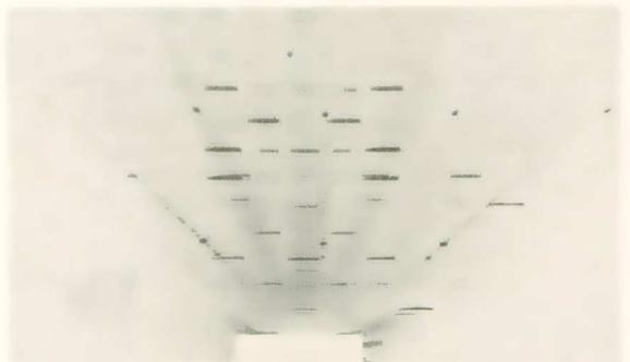
und 101 um  $30^\circ$  bei Verwendung von Rh-Strahlung erreicht wurden (Abstand der Krystallplatte 63,64 cm.). Die beobachteten Reflexe sind in beifolgenden Tabellen enthalten.
