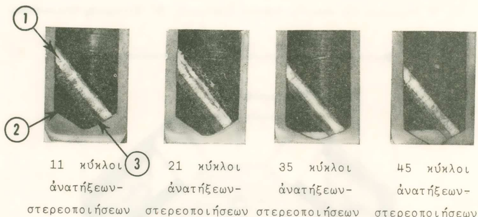
Εἰκ. 2. Διαχωρισμὸς τῶν φάσεων εὐτηκτικοῦ κράματος Bi + Cd μετὰ 11 - 21 - 35 καὶ 45 κύκλους ἀνατήξεων - στερεοποιήσεων καὶ διὰ συχνότητα περιστροφῆς 13.300 περιστροφῶν/min.
