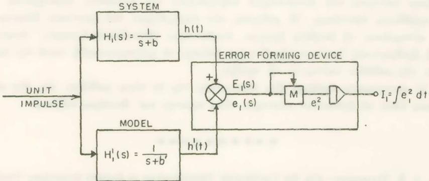
FIGURE 2: BLOCK DIAGRAM FOR THE IDENTIFICATION OF ONE-PARAMETER SYSTEM
