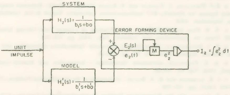
FIGURE 3: BLOCK DIAGRAM FOR THE IDENTIFICATION OF THE TWO-PARAMETER SYSTEM.
