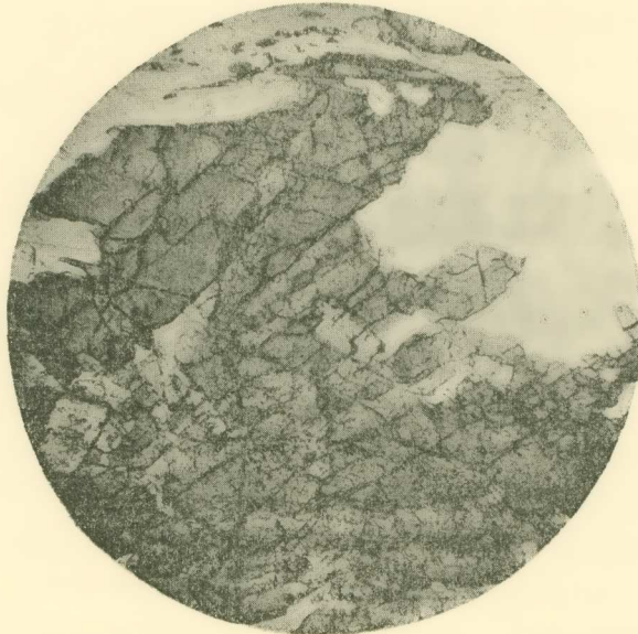
Είκ. 3.— Μικρὸς κρύσταλλος γλανκοφανοῦς (εἰς τὸ κέντρον), ἐντὸς τοῦ ὁποίου συνεχίζεται ὁ σχισμὸς τῶν περιβαλλόντων αὐτὸν κρυστάλλων τῶν κvanoπρασίνων ἀμφιβόλων. Nicols || (×34).
