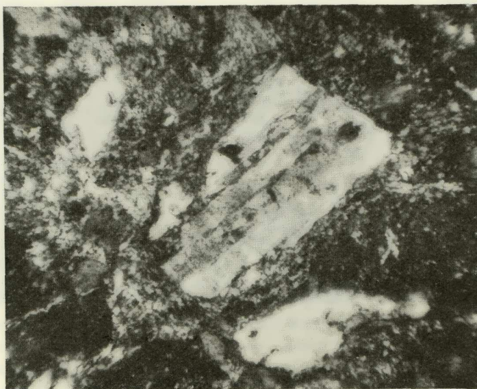
Εἰκ. 4. Πολύδωμος κρύσταλλος πλαγιόκλαστου ἐν τῇ πορείᾳ μετατροπῆς πρὸς ἀλβίτην, μὲ διατήρησιν τῆς ἀρχικῆς μορφῆς αὐτοῦ. Αἱ σκοτεινότεραι ζῶναι καὶ κηλίδες εἰς τὸ ἐσωτερικὸν τοῦ κρυστάλλου ἀνταποκρίνονται εἰς τὴν ἀρχικὴν βασικὴν σύστασιν αὐτοῦ. Σμικρότατοι πολυπληθεῖς κρύσταλλοι πρενίτου ἀναπτύσσονται πέριξ τοῦ θεωρουμένου κρυστάλλου τοῦ πλαγιόκλαστου. Σπιλιτῆς περιοχῆς Κατάρας Μετσόβου. Nicols +, \times 120 .
