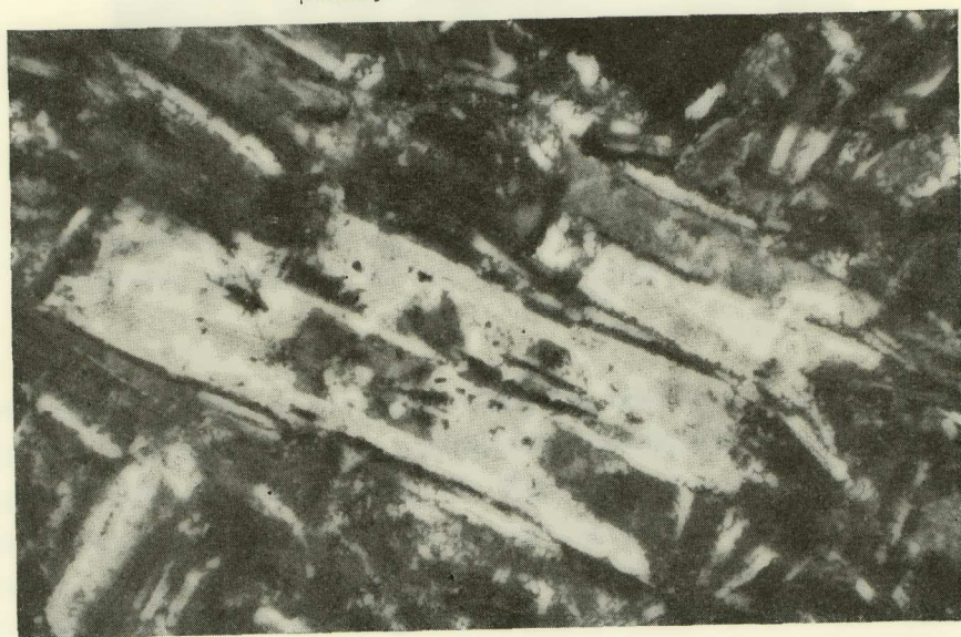
Εικ. 2. Τὰ αὐτὰ φαινόμενα, ὡς περιγράφονται διὰ τὴν εἰκ. 1. Παράλληλα ἐπίπεδα πολυδυμίας τοῦ ἀρχικοῦ κρυστάλλου διαγράφονται διὰ λεπτῶν ζωνῶν ἀλβιτιώσεως. Σπιλίτης, δυτικῶς Παναγίας (Ν. Κουτσούφλιανης) Καλαμπάκας. Nicols +, \times 120 .
